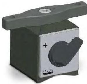
Der schaltbare Magnethalter wird eingesetzt, um den R545 oder T250 mit Adapterplatte BG 830780 auf einer Messfläche zu befestigen. Die Quertraverse nimmt dafür die Haltestange BT 948157 auf, an der der R545 arretiert und in der Höhe verschoben werden kann.
